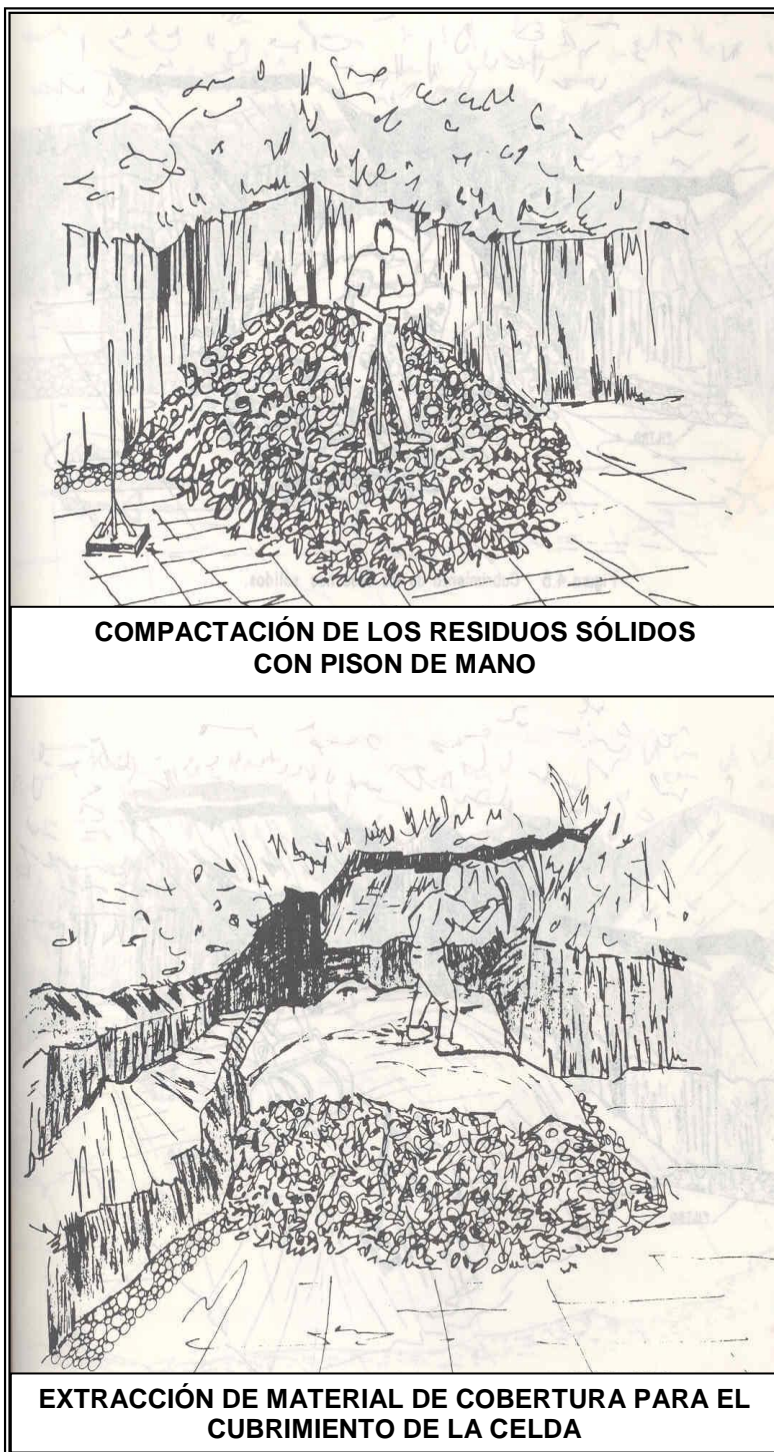
Figura 11. Compactación de la celda
